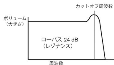
**Resonance** を高い値に設定すると、出力信号レベル、つまりシンセのボリュームを著しく増幅させることができますが、望まないクリッピングが発生する場合があります。これは、**VCA Gain** [24] を調整することで補えます。
