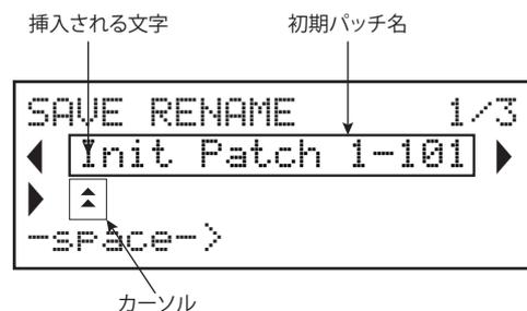
ここでは、パッチに任意の名前を登録することができます。既存の名前が最初に表示されるので、2行目のボタン (▶) を使用して変更する文字の位置までカーソルを移動し、次にロータリーのパラメータコントロール [10] を使用して、一文字ずつ選択していきます。一文字ずつ設定していきま。大文字、小文字、数字、句読点やスペース記号の全てがロータリーコントロールから選択できます。文字の代わりにスペースを入力したい場合には、4行目のボタンを使用します。新しい名前を入力し終えたら **Page▶** を押して2ページに移動し、編集後のパッチが保存されるメモリロケーションを指定します。
