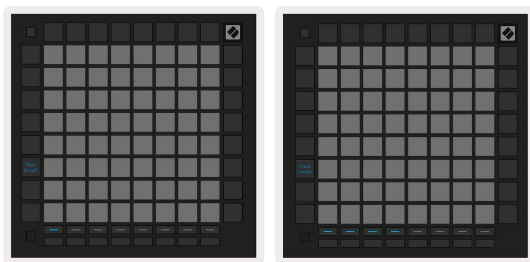
5.3.7.A – Setarea numărului de bare cu butoanele de selectare a piesei pentru lungime fixă. O lungime fixă de 1 bară este văzută în imaginea din stânga și 4 bare în dreapta.
