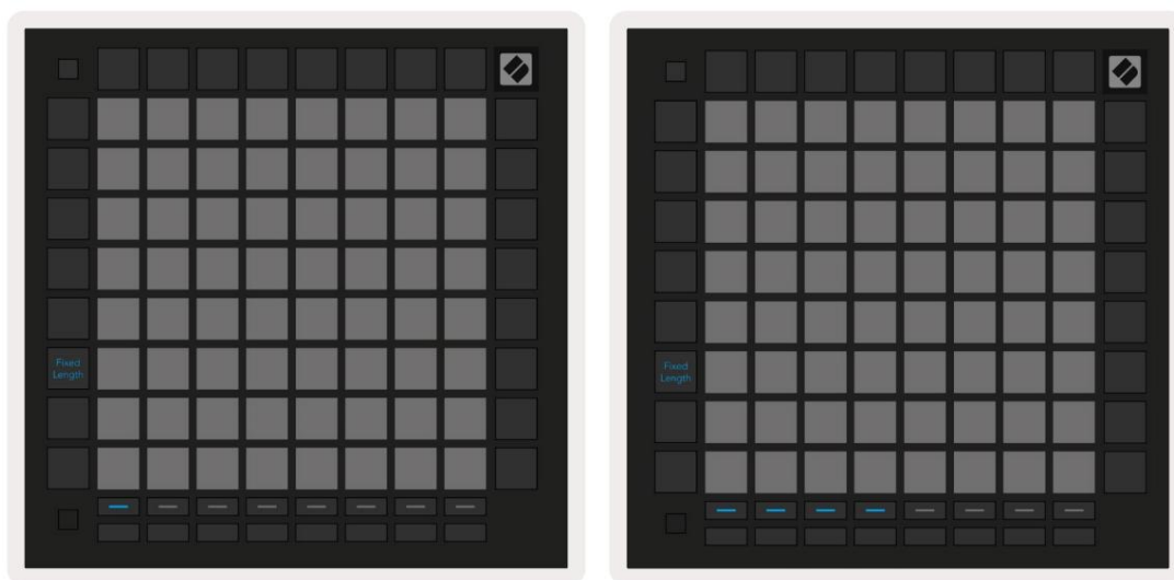
5.3.7.A – Задаване на броя на лентите с бутоните за избор на песен за фиксирана дължина. На лявото изображение се вижда фиксирана дължина от 1 черта и 4 черти вдясно.
